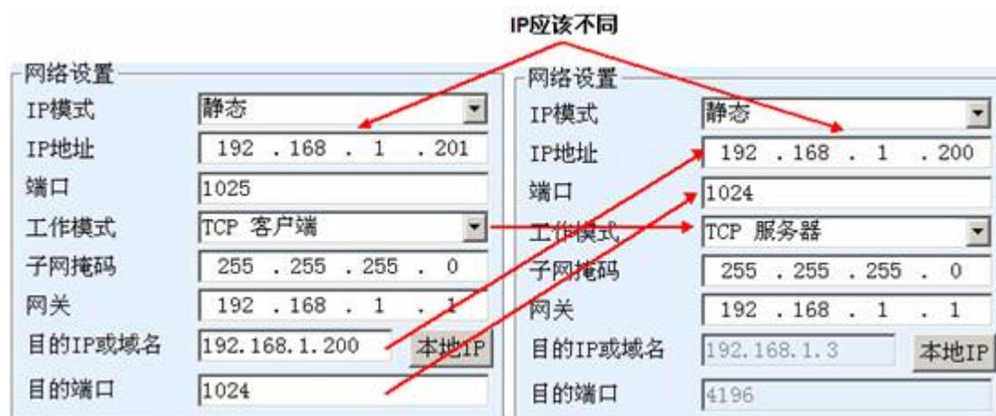
图 24 TCP 设备对联参数配置
